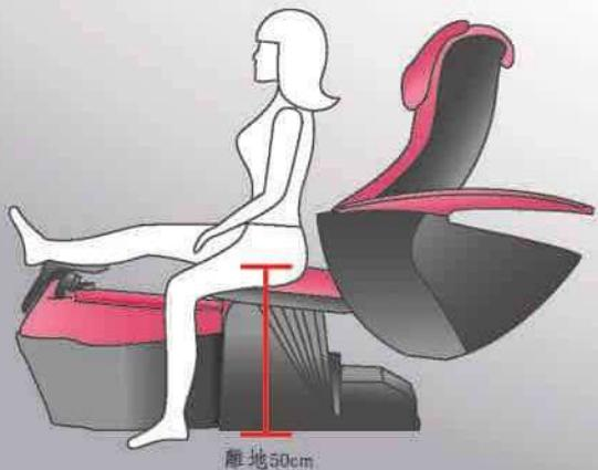
將椅墊往前調整時，椅墊將降低至50cm之離地高度，此時推開扶手向後，顧客站立在地面即可坐上沙發，避免傳統的讓顧客站上水盆裡再轉身坐上沙發，而發生危險。
